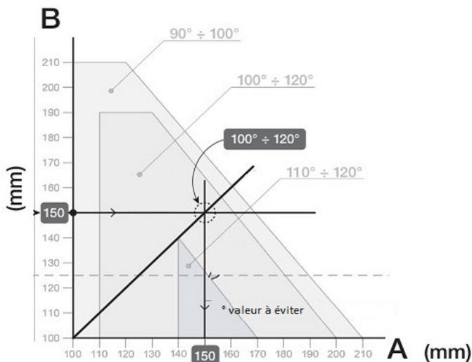
Attention la cote A maxi, patte de fixation comprise est de 200 mm => l'axe des pivots du portail doit être près du bord intérieur du pilier
