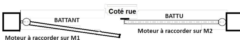
Le « BATTANT » s'ouvre en premier et se referme en dernier. (**NB :** si c'est un portail avec 1 seul battant, on utilise le bornier M1)
