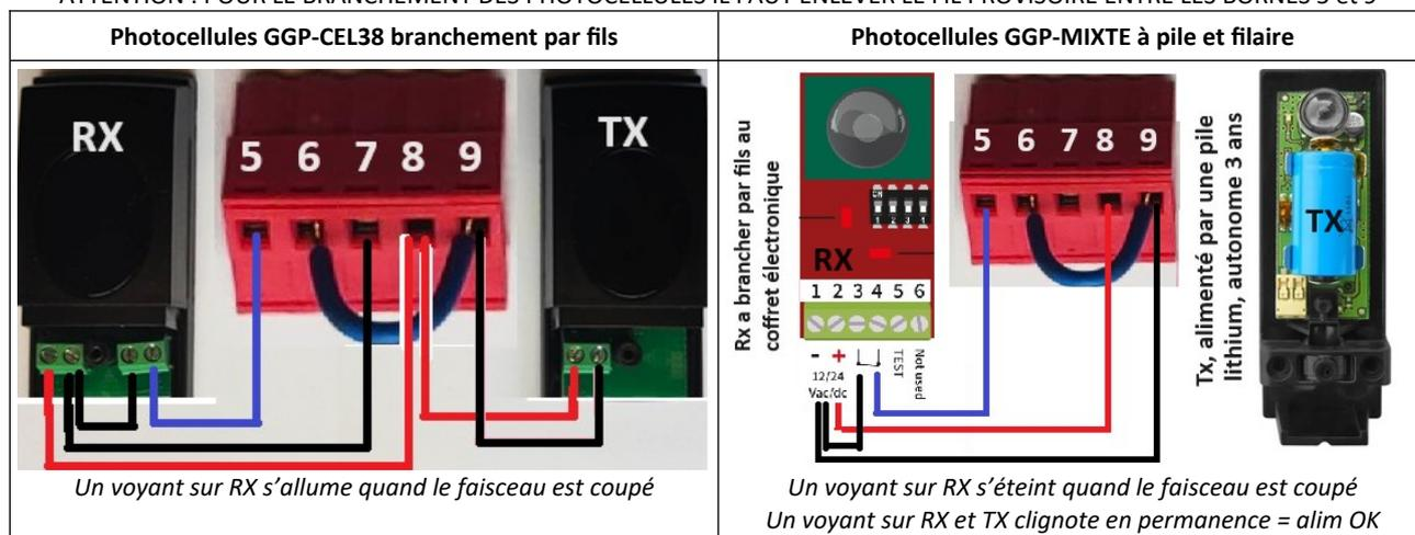
Contrôle : En passant la main devant le faisceau entre les 2 photocellules la Led **PC.C** sur la carte électronique, s'éteint.**9-2° Branchement des fils pour les commandes d'ouverture total et ouverture piéton :**
